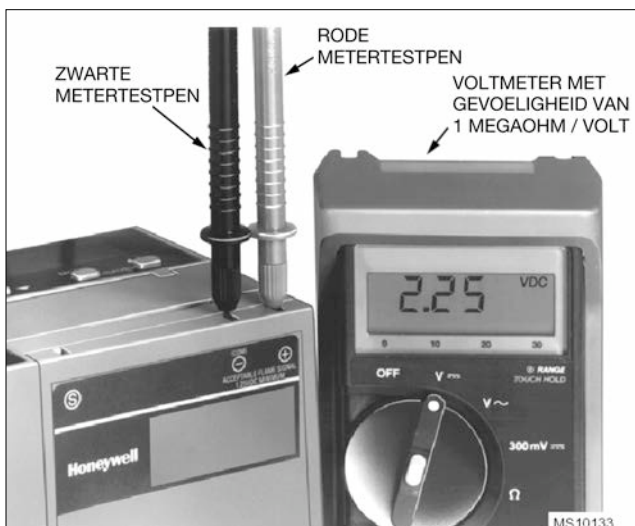
Afb. 11. Meting van het voltage van het vlamsignaal op regelingen van de 7800 SERIE
