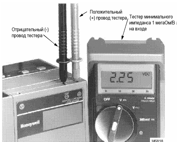
Рис. 19. Измерение напряжения сигнала пламени на регуляторах серии 7800.
