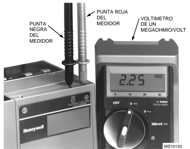
Fig. 9. Midiendo Voltage de la Señal de Llama con Controles de la SERIE 7800.
